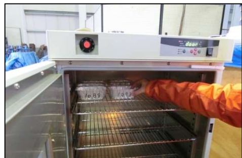
図表 5.7 乾燥機と試料の入った試料皿
