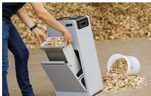
図表 5.12 木質バイオマス用誘電率水分計（オーストリア Scheller 社カタログより）
