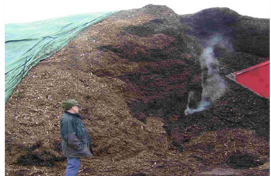
図表 1.17 木質チップ堆積層での自然発火
