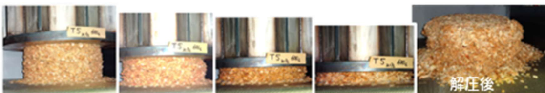
図表2.20 チップケーキの圧縮脱水・解圧
